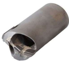
複刃 ロウ付けソリッド 1枚刃に比べて高送りが可能 加工面品質にも優れ、寸法公差・同芯の高い加工が可能
