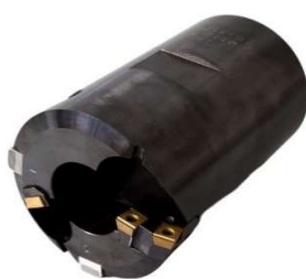
トレパニング 芯を残して加工する方法で切削加工の負担を軽減することで大径の孔明け加工が可能
