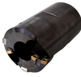
トレパニング 芯を残して加工する方法で切削加工の負担を軽減することで大径の穴明け加工が可能
