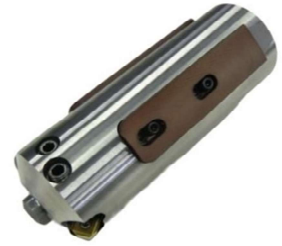
カウンターヘッド パイプ状態の穴を広げる加工方法 内径寸法を上げたり、ホーニング加工の下穴加工
