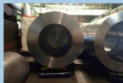
内径φ390 深さ955L 止り穴加工 材質 S35C
