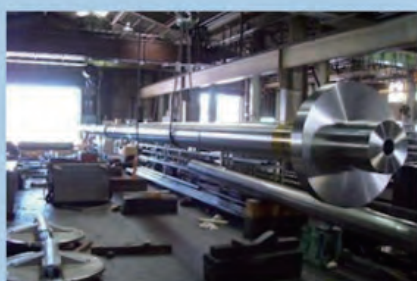
プロペラ軸 19,900L 材質 KSF60
